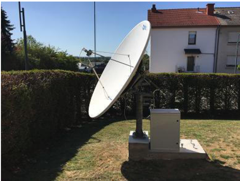
Die 1.8m Prime Focus Antenne mit RX/TX Feed
