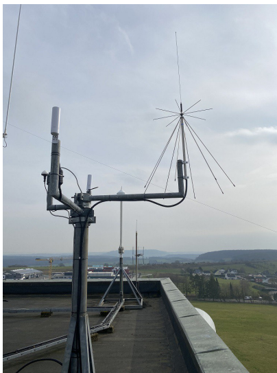
D'Disccone-antenn vum Airspy-SDR-Rx
